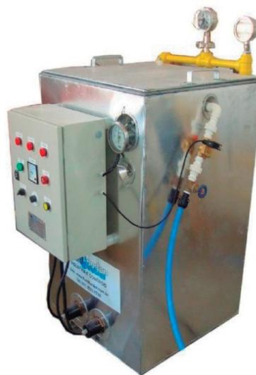
**Indicador de temperatura do gás:** Medidor tipo bimetálico, 69 mm de diâmetro, 0 - 120°C
